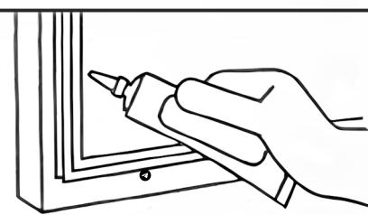
Если монтаж уплотнителя требует приклевания к поверхности, то перед началом работ необходимо произвести обезжиривание.
