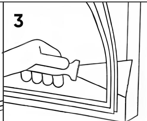
Срежьте уплотнитель с помощью шпателья (или отвертки), если он приклеен к двери.
