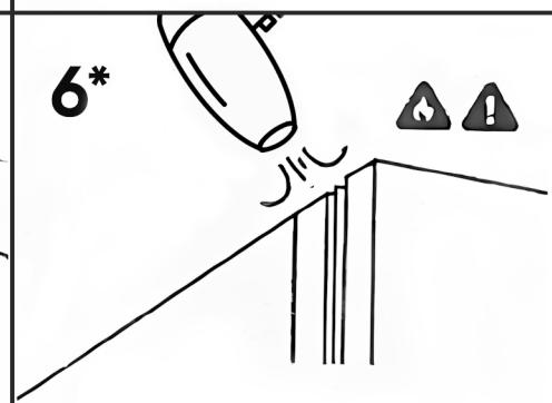
Во избежании щелей следите за корректным примыканием углов уплотнителя, избегайте чрезмерного натяжения.
