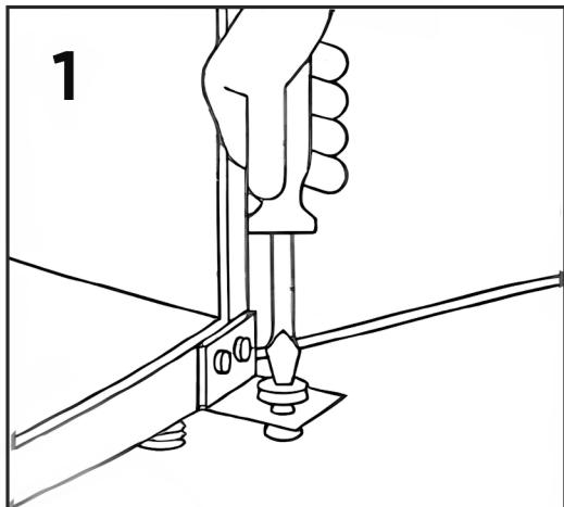
Снять дверцу холодильника, после чего установить ее на ровную поверхность.
